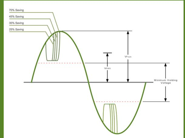
อีกประการหนึ่ง หลักการระบบ N.C.W.I. ใช้หลักการตัดต่อติดต่อแบบ อิเล็กทรอนิกส์ จึงมีขนาดเล็กและมีการสูญเสียในตัวองต่ำ (Low Insertion Loss) ซึ่งเมื่อเปรียบเทียบกับระบบอื่นๆ ที่ใช้อุปกรณ์ reactive แล้ว ถือว่าระบบ Power Controller แบบ Non Critical Wave Intersection มีประสิทธิภาพที่ดีกว่ามาก
